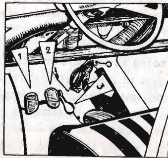
SL. 32 — LEVA NOGA SE NE SME STALNO DRZATI NA PEDALI KVACILA (1). PEDALU NOZNE KOČNICE (2) NEMOJTE PRITISKATI NAGLO KAO KADA PRITISKATE PEDALU KVACILA (SEM U SLUCAJU NEOPHODNOSTI IZRAZITO NAGLOG KOČENJA). NEPODMAZANA SAJLA ZA GAS PROUZROKUJE DA SE PEDALA ZA GAS (3) TEŽE VRACA U NORMALAN POLOZAJ
