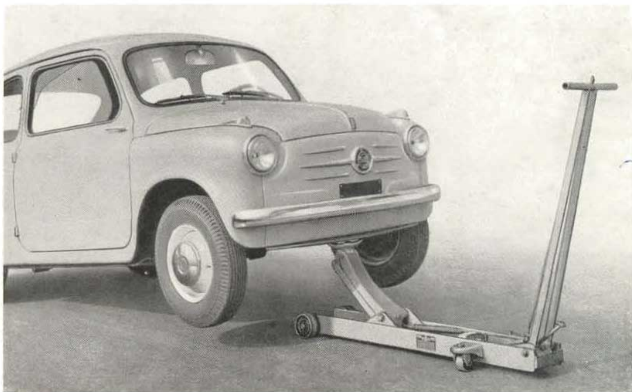
Sl. 53. - Izdizanje prednjeg dela vozila pomoću hidraulične dizalice.
